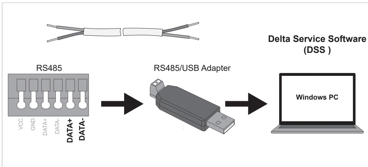
Raccorder le PC à l'onduleur via l'adaptateur RS485/USB.
