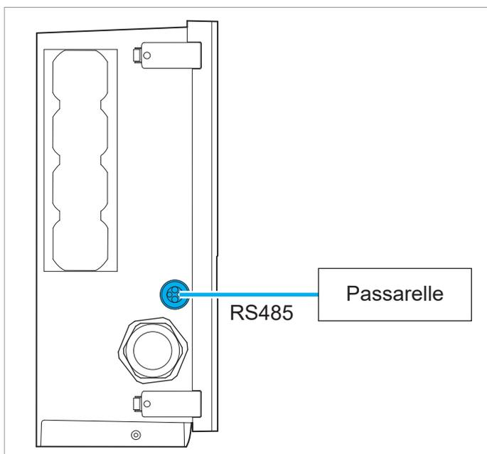
Activer la résistance de terminaison RS485 de l'enregistreur de données ou raccorder une résistance de terminaison.
