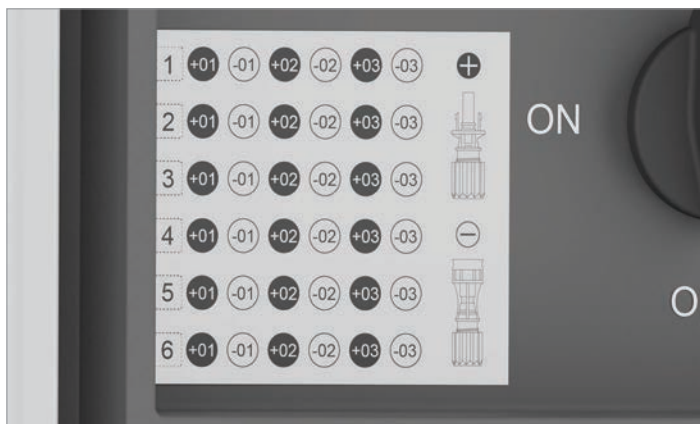
Abb. 4.7: Etikett mit der Zuordnung der einzelnen DC-Steckverbinder
