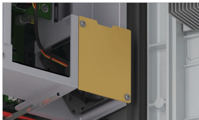
Fig. 4.19: Posición del ventilador 2 interno
