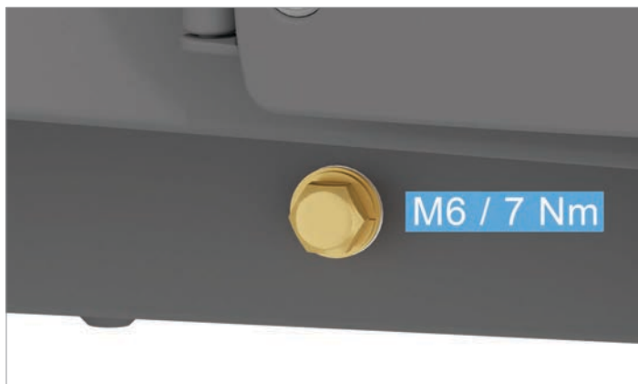
Fig. 4.14: Posición de la conexión a tierra externa en la pata izquierda del inversor
