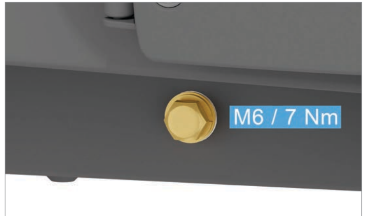
Fig. 5.32 : Position de la prise de terre externe
