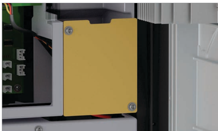
Position du ventilateur interne 2
