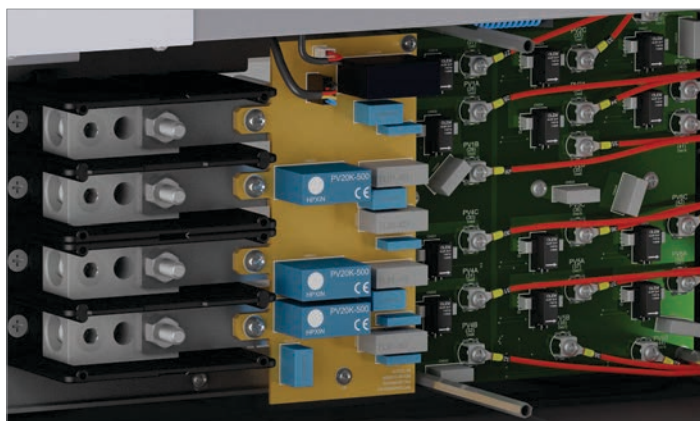
Fig. 4.5 : Aperçu du limiteur de surtension AC lorsque le couvercle de protection est retiré
